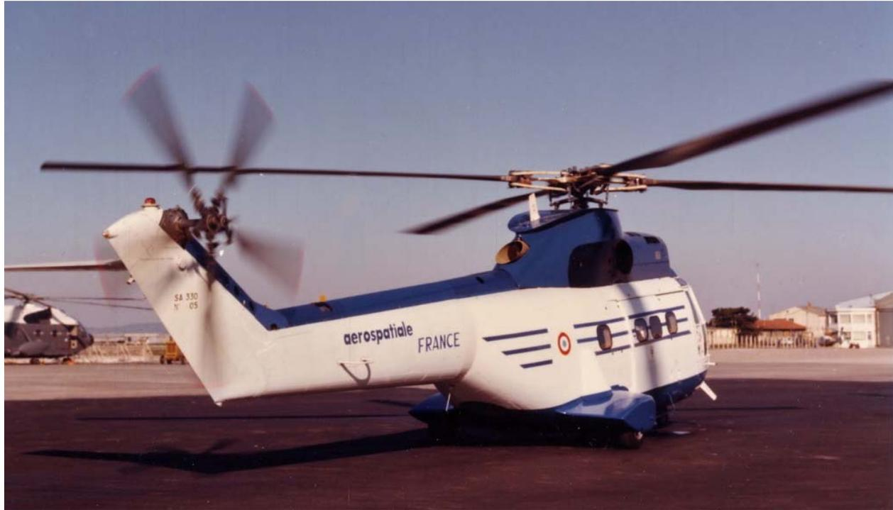
*Le SA 330 R équipé du moyeu rotor Starflex et du moyeu arrière classique. Copyright EC.*
