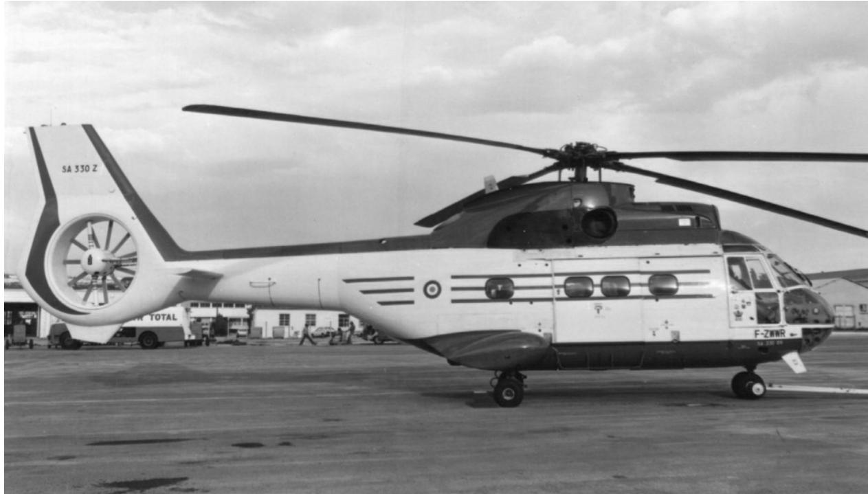
*Ici le plan fixe est logé dans la poutre de queue du Puma prototype. Copyright EC, Hélimat.*
