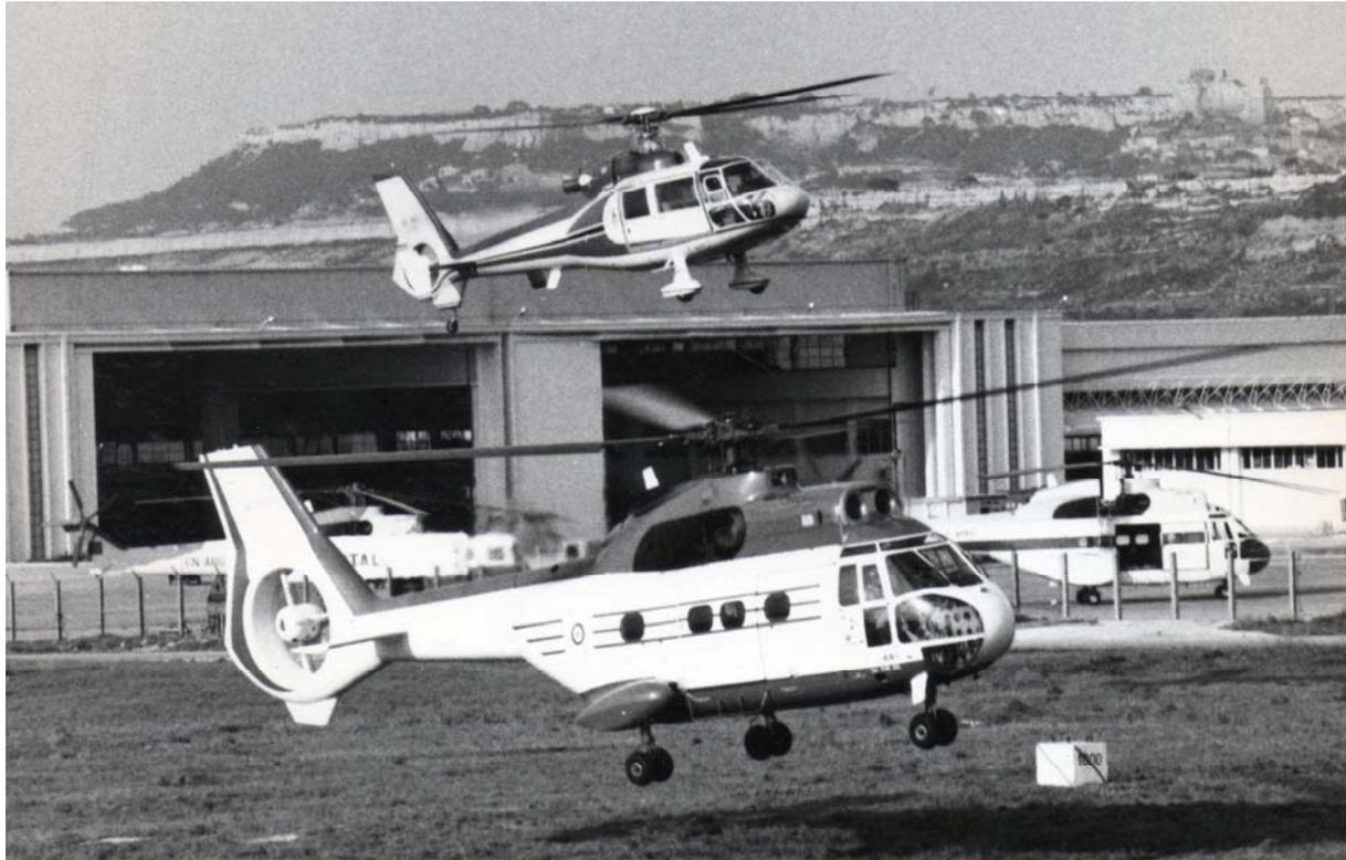
*Le Puma équipé du rotor principal classique et du rotor Fenestron. Copyright EC, D.Liron.*
