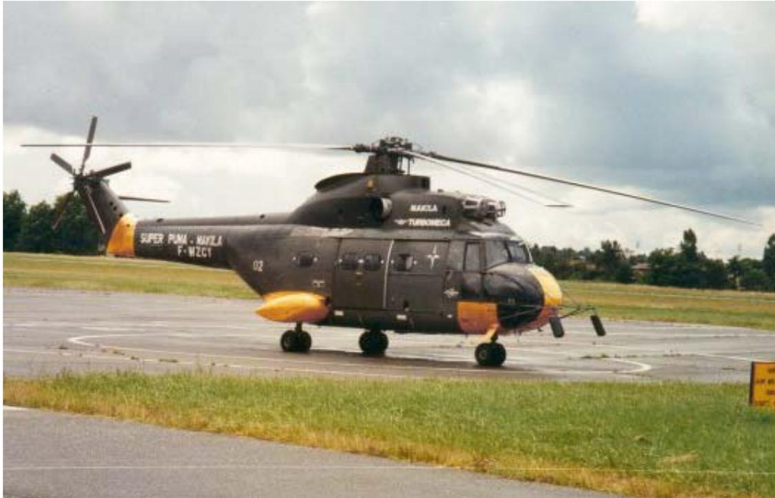
*Le banc d'essais volant de la CGTM, le SA 330 Ba N°02 équipé de Makila 1A.*
