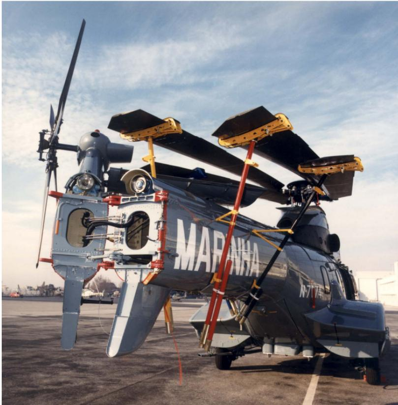
Une centrale de repliage assure l'alimentation d'un vérin hydraulique pour les manoeuvres.
