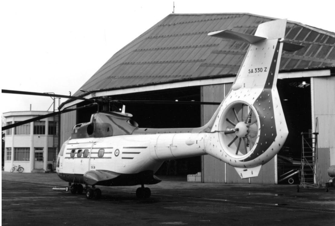
*L'exceptionnel rotor Fenestron à 11 pales de 1,60 m de diamètre. Le plan fixe est installé sur la dérive surdimensionnée allongée de quelques cm. Copyright EC, D.Liron.*
