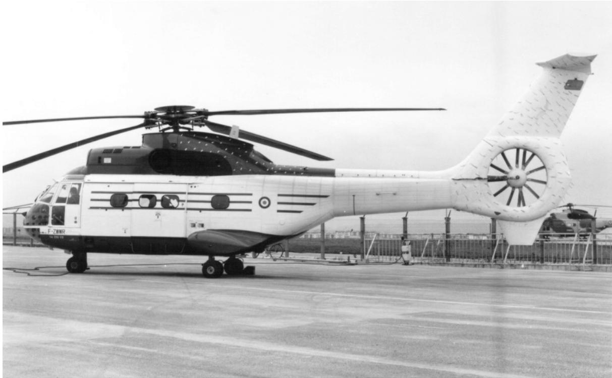
*Le SA 330 Z équipé du moyeu rotor principal Starflex et d'une coupole anti-sillage.
