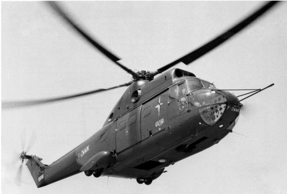
*Le prototype N°01 au cours d'un vol d'essais. Remarquer l'ancienne définition de la verrière, des capots et des marchepieds.*
