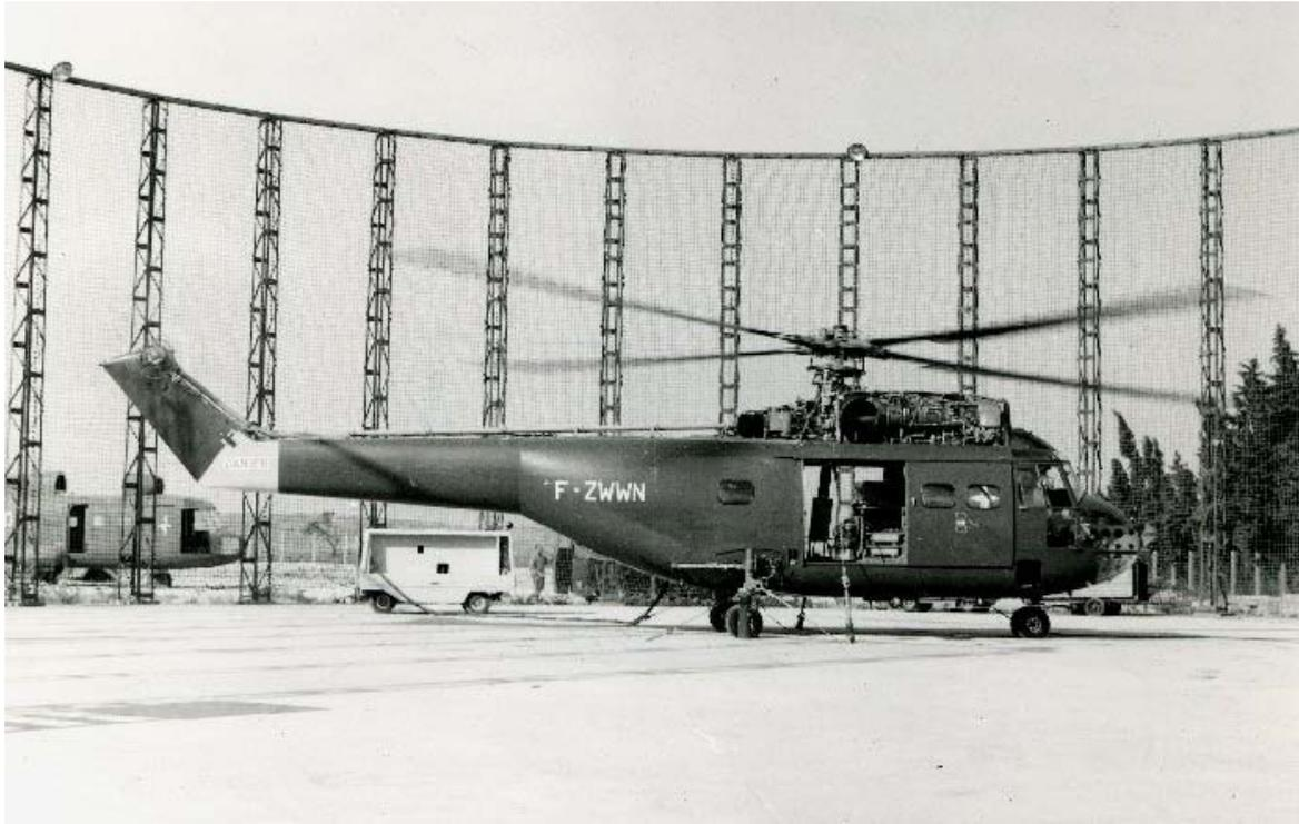
*L'appareil dans « la cage aux lions » de Marignane dans laquelle les turbomoteurs et la chaîne dynamique subirent de sévères contraintes d'endurance.*
